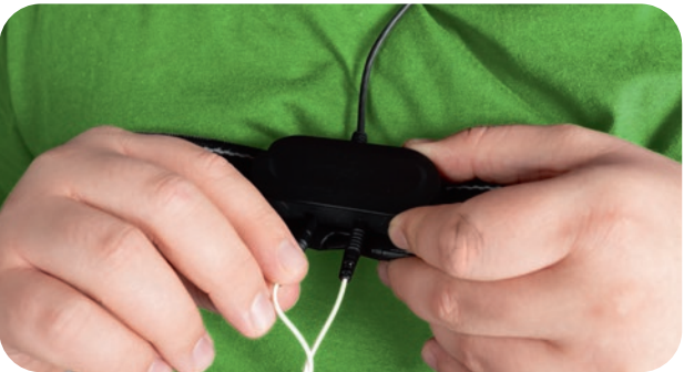
Cảm biến gắng sức hô hấp và tư thế cơ thể được gắn vào đai cảm ứng ngực
