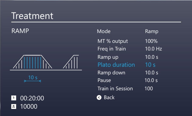
Chế độ Ramp. Kích thích lặp đi lặp lại theo train với biên độ dốc lên và dốc xuống.
